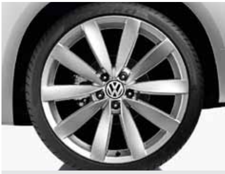
Lättmetallfälg "Interlagos" 8 J x 18" med däck 235/40 R18.
