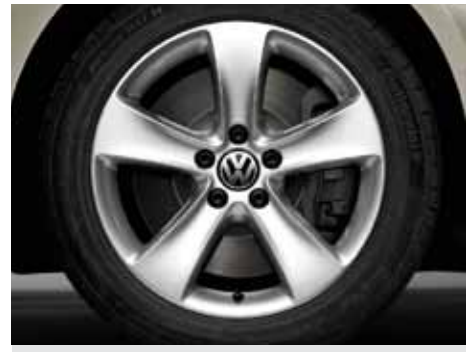
Lättmetallfälg "Daytona" 8 J x 18" med däck 235/40 R18.
