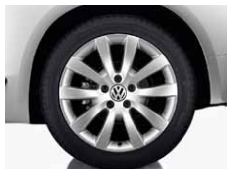
Lättmetallfälg "Long Beach" 7 J x 17" med däck 225/45 R17 är både dynamiska och eleganta. Standard TSI 160.
