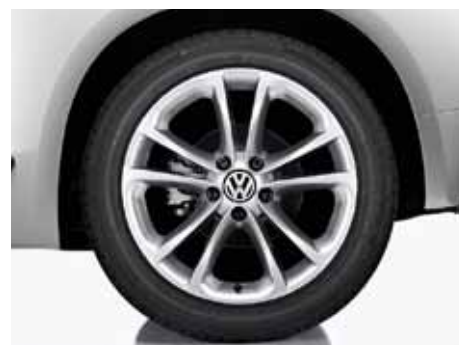
Lättmetallfälg "Spa" 8 J x 17" med däck 225/45 R17 är standard på GT.
