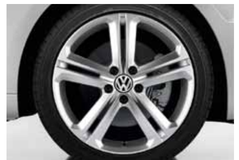
Lättmetallfälgar "Mallory" 8Jx17 med däck 235/45 R17 finns även i 18 tums dimension som tillval.
