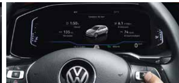
ACTIVE INFODISPLAY | T Med Active Info Display visas den viktigaste informationen digitalt på en högupplöst 12,3-tums skärm. Förutom varvräknare och hastighetsmätare kan du få informationen du behöver presenterad på olika sätt. Väljer du Navigation flyttas hastighetsmätaren och varvräknaren ut mot sidorna för att ge plats för kartan i mitten.
