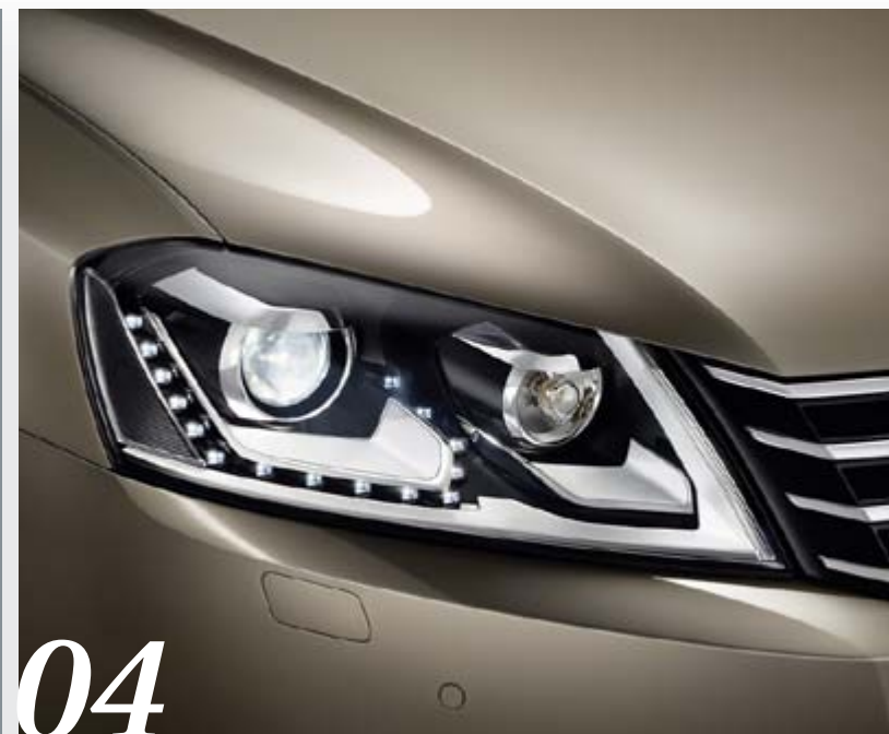
Bi-xenonstrålkastare med LED-varselljus
