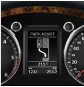
ParkAssist, en unik innovation från Volkswagen som tar över styrningen vid fickparkering.
