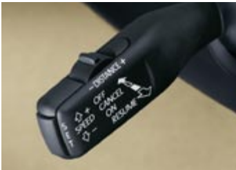
Farthållare med distansradar.
