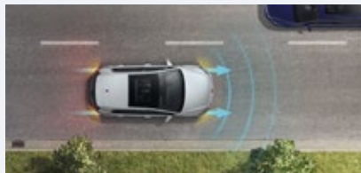
Emergency Assist. Bromsar ned bilen till stillastående i en nödsituation.
