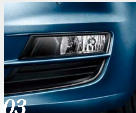
Dimstrålkastare med statiskt kurvlyjus
